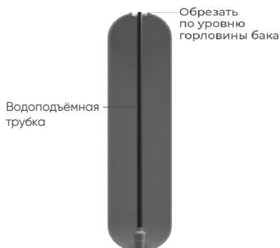
Обрезка водоподъемной трубы
